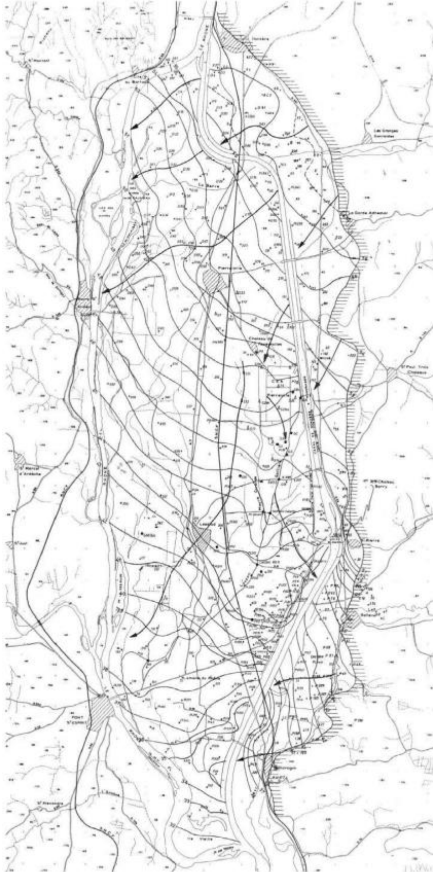
Figure 16 : Extrait de l'étude de la ZABR sur les échanges nappe/rivière, piézométrie issue des travaux de Guégan 1972.
