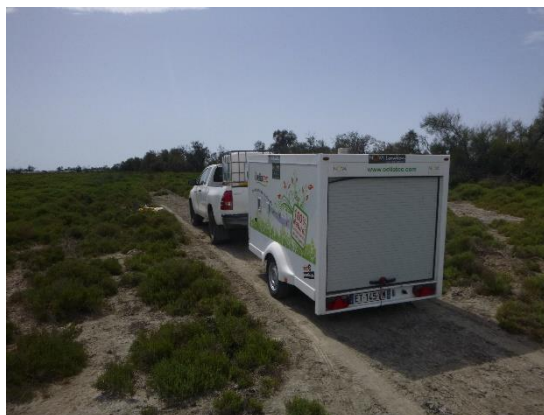
Désherbeur à eau chaud sur remorque © P. AUDA
