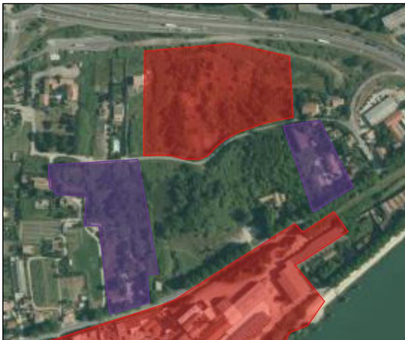
Figure 17 – Cartographie schématique globale des zones à risques (ERG, 2016) (en rouge ; les zones d'activité historique potentiellement polluante ; en violet, les zones de risque pyrotechnique (dépôts de munition, bombardement))
