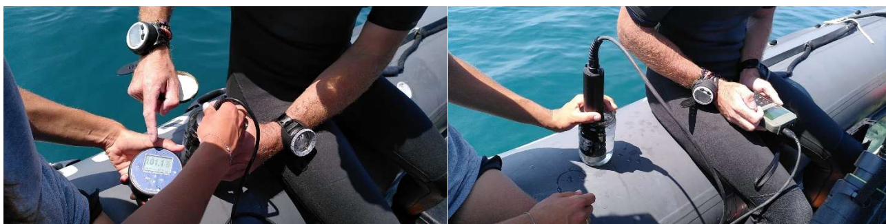
Figure 4 : Oxymètre et sonde multiparamètres pour mesures de la qualité d'eaux prélevés sur le fond (© PNRC)
