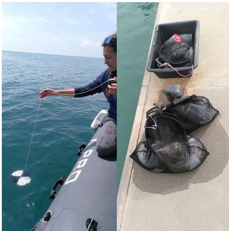
Figure 3 : Mesure de la turbidité au disque de Secchi et matériel de prélèvement ; Matériel de prélèvement et de conditionnement des échantillons d'eaux et de sédiments prélevés sur le fond (© PNRC)
